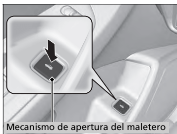
Mecanismo de apertura del maletero
